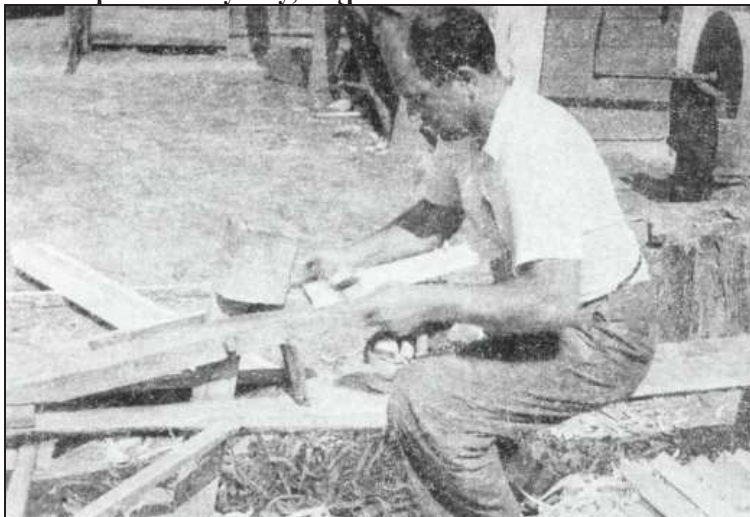
Rysunek 16. Obrabianie klepki na Kobylnicy, Skępe
